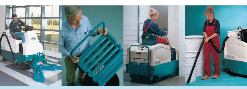
Avec son ingénierie de qualité et son alimentation à batterie sans émanations, le 6100 fournit un fonctionnement pratiquement continu sur une variété de surfaces de plancher. Le nettoyage efficace en une passe avec manœuvrabilité aisée dans les espaces restreints augmente la productivité.
